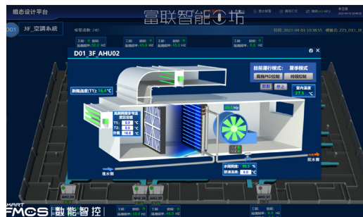
空调系统操作画面
